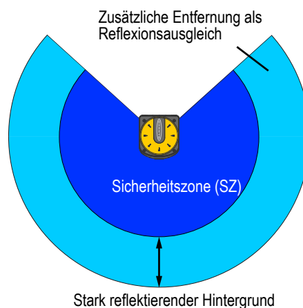
Abbildung 24. Stark reflektierenden Hintergrund reduzieren oder entfernen
